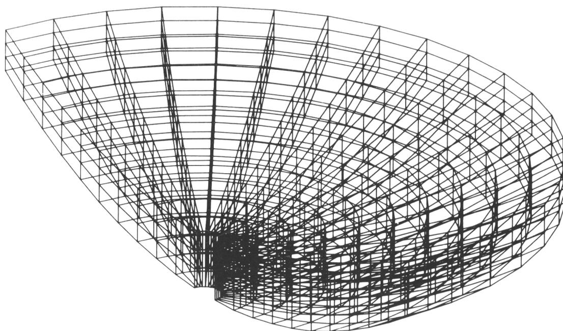
Fig. 4 MODEL OF PRIME FOCUS CORRECTOR FRONT ELEMENT
