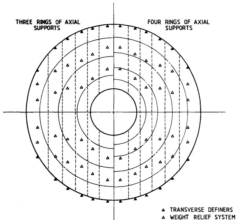
Fig. 11 PROPOSED SUPPORT SYSTEMS FOR 7.5m HONEYCOMB MIRROR
