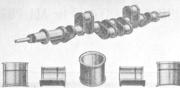
— AERO. ENGINE CRANK-SHAFT AND BEARINGS. —
